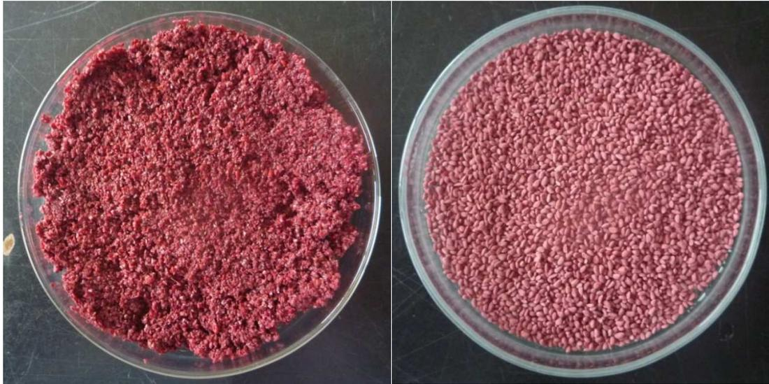
**Figura 4. Aspecto de los residuos finos (izquierda) y gruesos (derecha) utilizados en la FMS en el estudio.**
