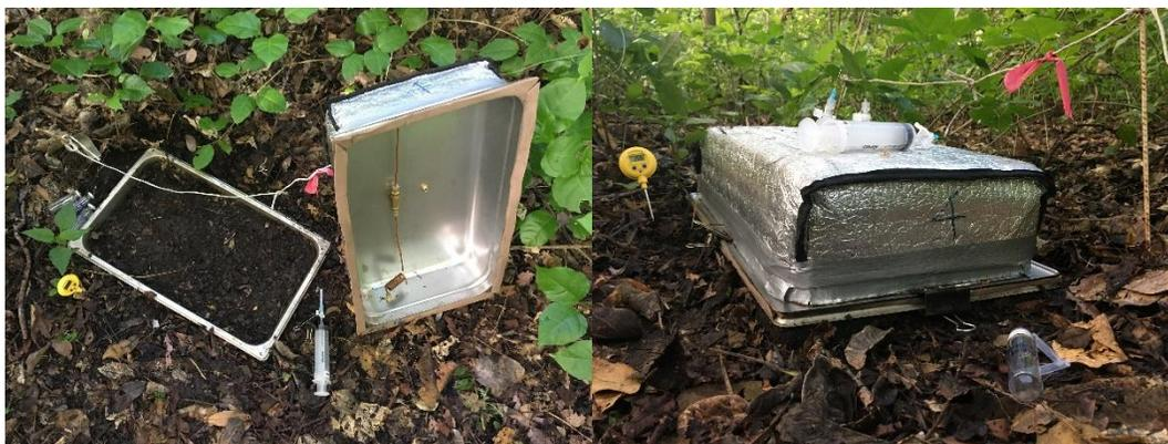
**Figura 2.** Cámaras utilizadas en el muestreo de gases de efecto invernadero. Las dimensiones de las tapas son 0.5 m de largo, 0.3 m de ancho y 0.1 m de alto.
