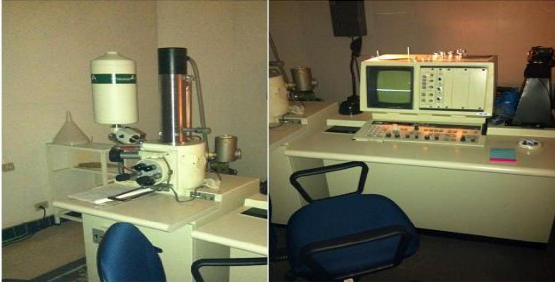
**Figura 6.** Microscopio Electrónico de Barrido Hitachi Modelo S570 del Centro de Investigaciones en Estructuras Microscópicas (CIEMIC) utilizado para tomar las fotos de los nematodos.
